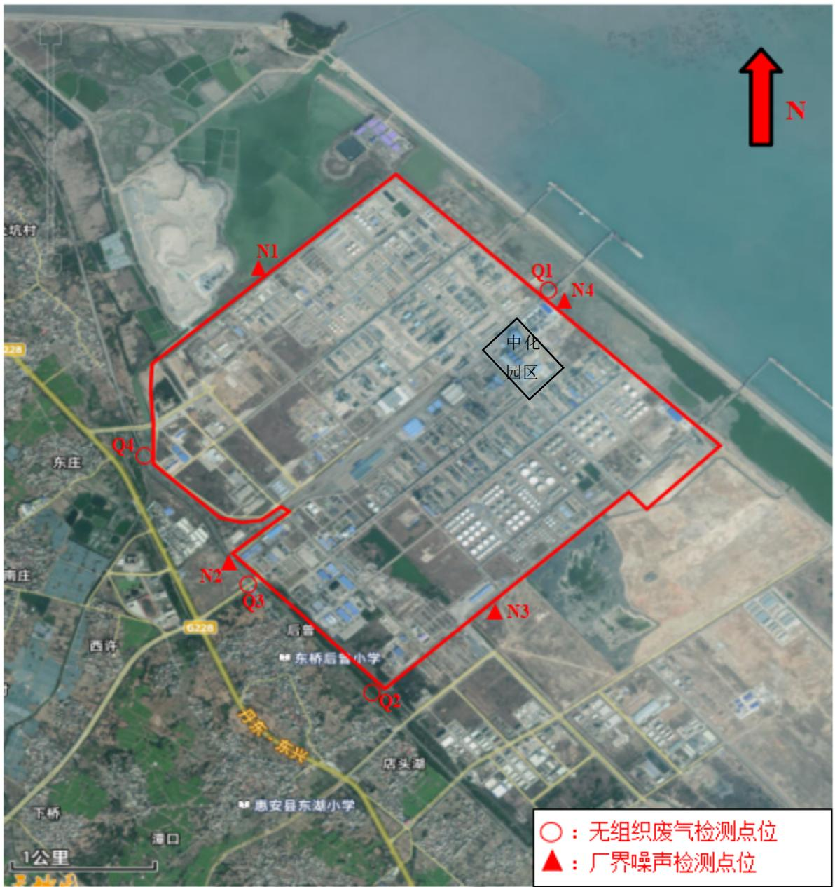
图 6-2 无组织废气和噪声监测点位示意图
